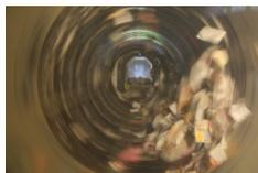
3 - Le processus du tri commence ensuite grâce à des machines et des outils à la pointe de l’innovation : des trommels (des machines en rotation avec des énormes tambours troués pour séparer la matière), des électroaimants (pour récupérer la ferraille), ou encore le tri optique (sorte de scanner qui reconnaît la matière des produits).
